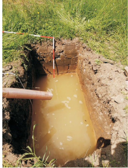
Bild 2: Infiltrationsversuch im Schurf S2; Blickrichtung NW
